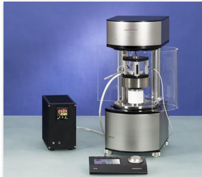
Hochtemperatur-Oberflächenspannungsmessung mit einem DCAT 25
