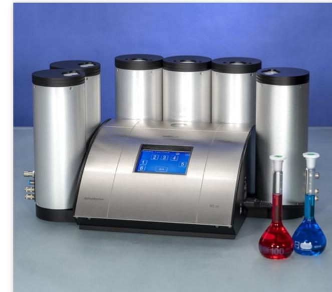
Dispersionsstabilitätsanalyse mit dem MultiScan MS 20
